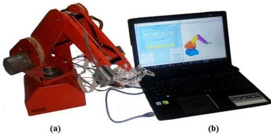
Figura 1. (a) Maqueta física de un brazo robótico de 4 Grados de Libertad, (b) PC con el software para controlar el brazo. (Fuente: Elaboración propia)
