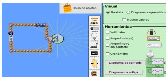
Fig. 2. Simulación del circuito propuesto con el interruptor cerrado. (Fuente: Elaboración propia)
